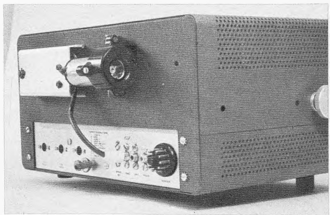
Bild 4. Lüfter und Wandler an der Rückseite des Transceivers
